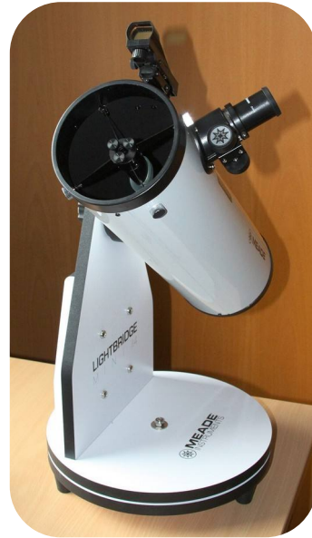
Photo P02 — Un Newton de table : le porte-oculaire est placé sur le côté, près de l'ouverture du tube.
