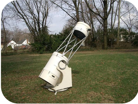
Photo P03 — Un Dobson à structure ouverte : le tube serrurier relie la cage du secondaire au barillet du miroir principal.
