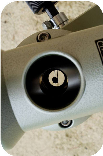
Photo P13 — L'ouverture du viseur polaire intégré à une monture Vixen GP-DX, utilisée pour la mise en station.
