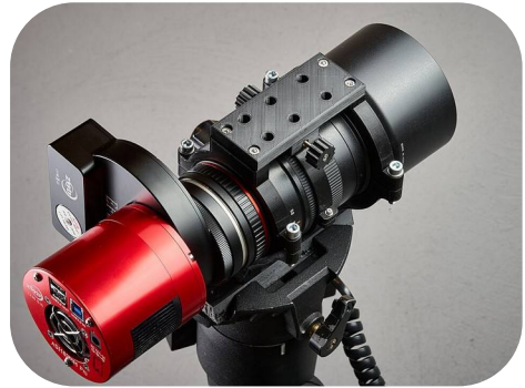
Photo P16 — Une caméra astronomique installée derrière un objectif Samyang 135 mm, dans un support dédié. Cette vue montre la fixation mécanique de la chaîne optique.
