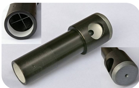
Photo P14 — Un outil de collimation Cheshire artisanal combiné à un tube de visée à réticule, présenté sous plusieurs angles.
