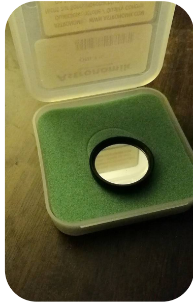
Photo P08 — Un filtre astronomique O III de 31,75 mm dans son étui. Ce filtre pour nébuleuses ne permet pas d'observer le Soleil.
